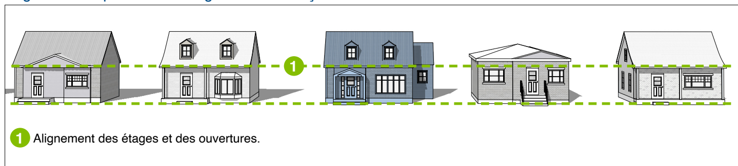
Figure 65 : Implantation et alignement des façades réussis
